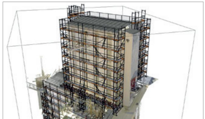
Abb. 1: Gebäude mit einer Punktwolke erfasst und digital eingerüstet.
